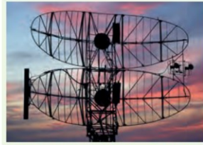
Gök yüzündeki cisimlerin yerini tespit eden radar cihazı
