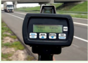
Trafikte hız tespiti yapan radar cihazı
