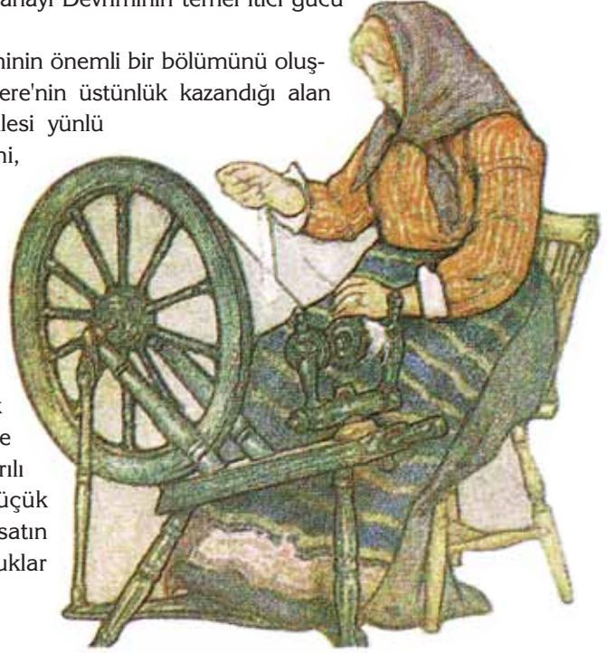
Resim 1: Elle ve ayakla çevrilen bir tekerlekten meydana gelen iplik yapma makinesi
